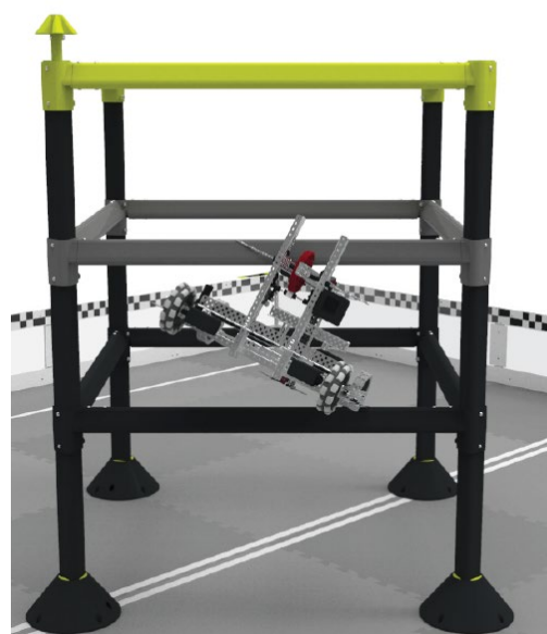
图 SC7-2：机器人仍接触第一条高塔横杆，因此，它处于第一层攀爬
